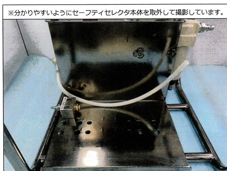
図2-4 マスタバルブ及びチューブの取外し後
